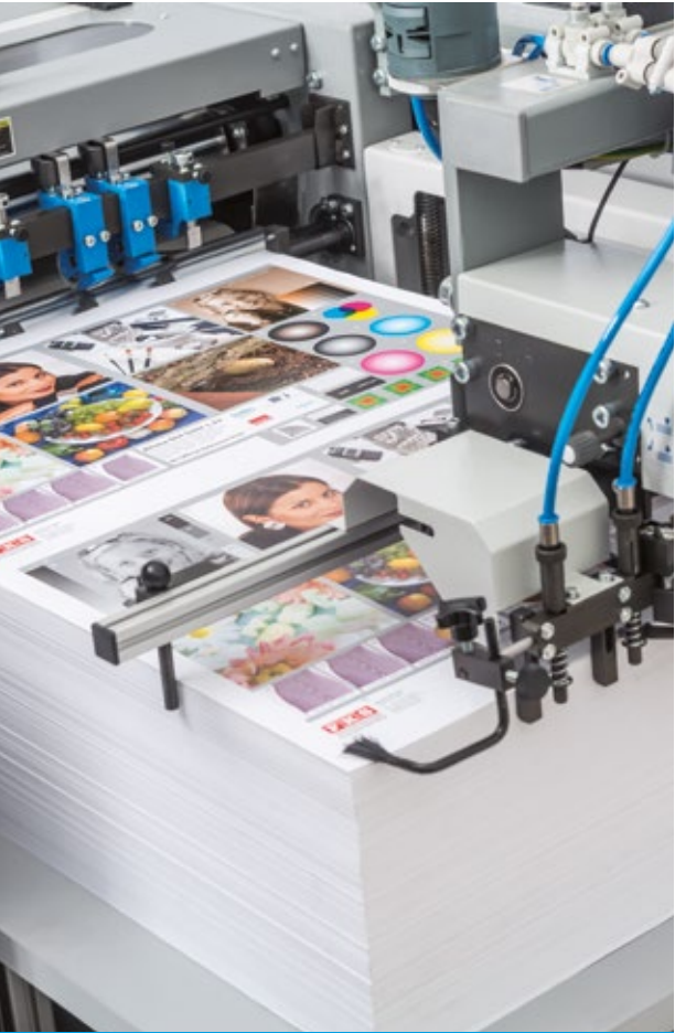
Stapelanleger mit Hub- und Schleppsaugern
