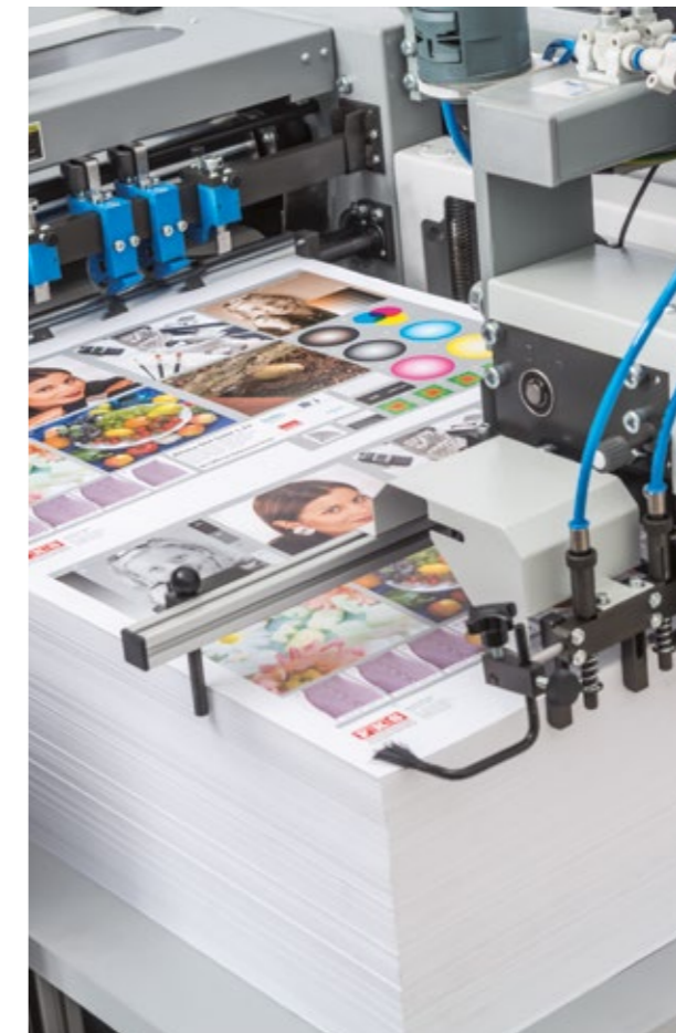
Stapelanleger mit Hub- und Schleppsaugern
